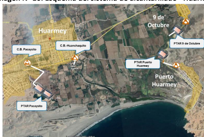
Imagen N° 16: Esquema del sistema de alcantarillado - Huarmey
